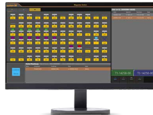
Magazinmanager – Funktion zur direkten Auftragskontrolle (unabhängiges Beladen, Auftragszuweisung usw.)
