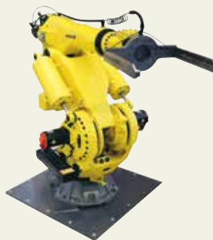
Automation - mit 6-achsigem Fanuc-Industrieroboter
